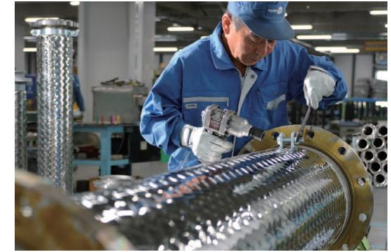
金属製フレキシブルホースの組み立て作業
