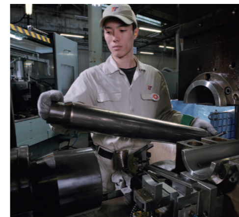
プロペラシャフトの生産現場 FRタイプの自動車に使用されているプロペラシャフト(エンジンから後輪に回転を伝えるパイプ部品)を多種類生産しています(約60,000本/月)
