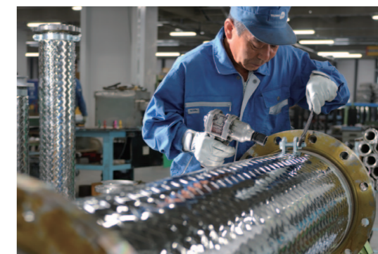
金属製フレキシブルホースの組み立て作業
