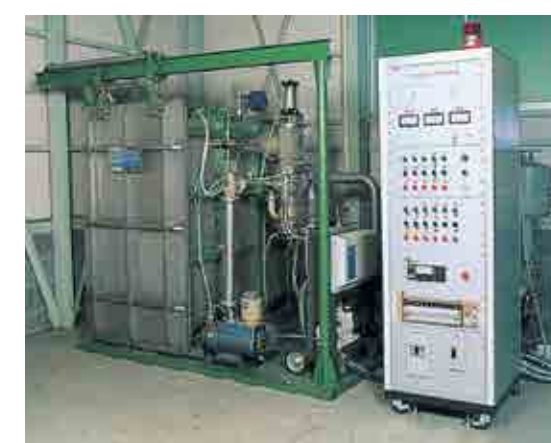
▼気密漏洩検査設備
