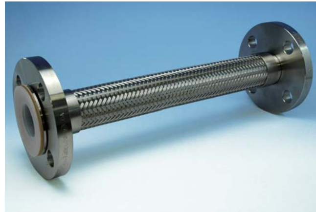
1 ルーズフランジ 2 フランジ金具 3 カラー 4 PTFEチューブ 5 ブレイド 6 ジョイントシート
